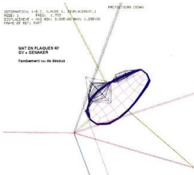
Exemple 4 idem en vue de dessus : effet de loupe sur le cas précédent: apparition de flambement local sur le flanc latéral en compression (capelage étau et galhaubans) (Aquitaine Innovation)
